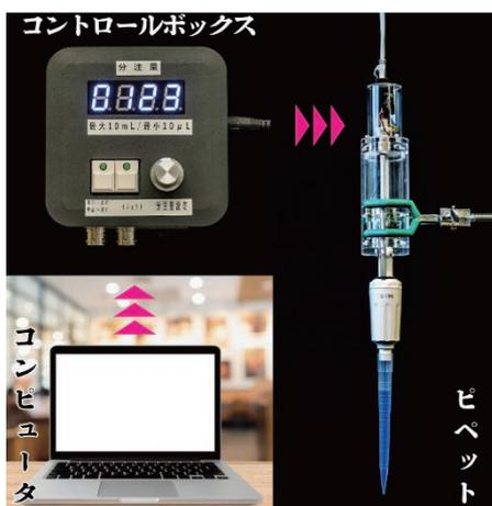
コントロールボックスを介してコンピュータでピペットを操作するシステム。
