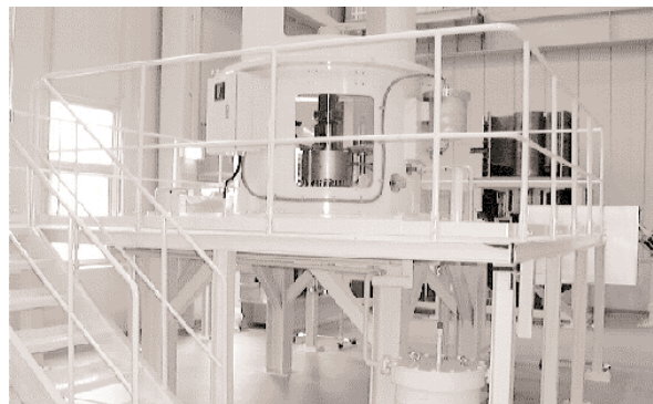
写真6 二次主冷却系循環ポンプ軸封部モデルの外観
