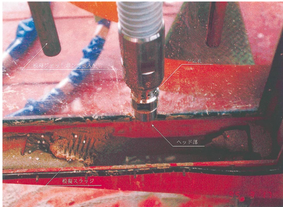
図6 模擬溶解槽からのスラッジの回収状況
