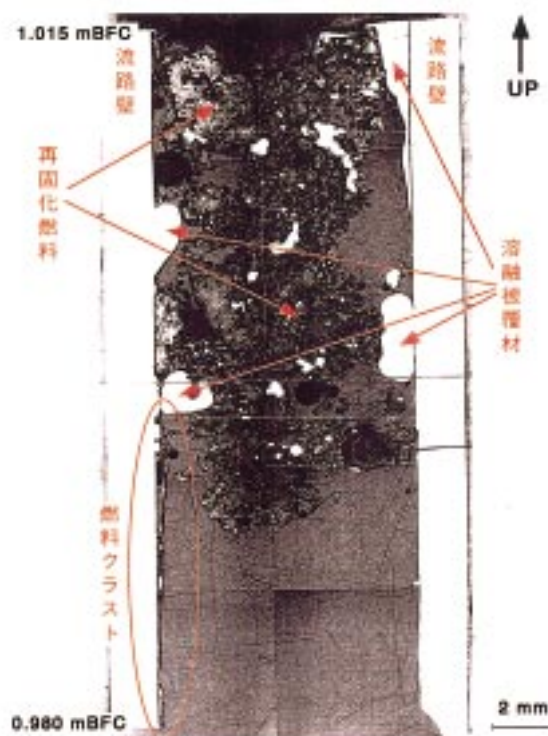
図11 試験後のテストセクション断面金相写真 (1.0mBFC付近)
