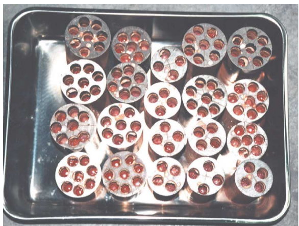
孔加工した炭素鋼への添加例
