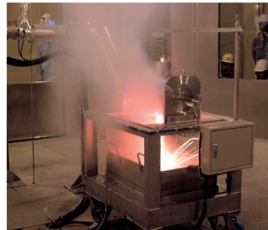
ナトリウム漏えい状況
