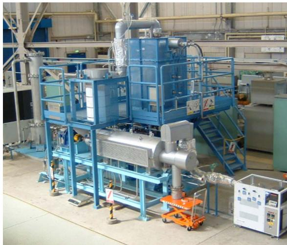
写真1 水蒸気改質処理試験装置
