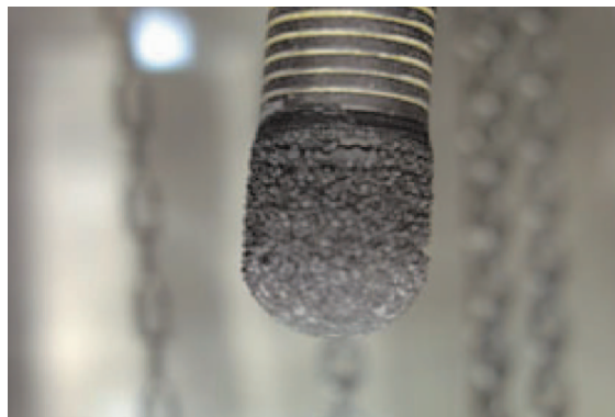
写真1 ウラン試験で回収したUO 2 析出物
