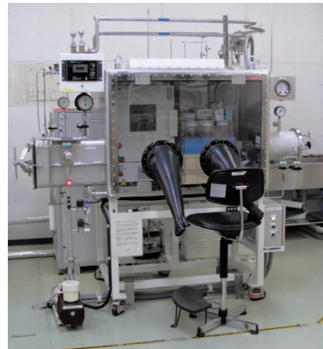
写真1 個別現象を解析するための実験を実施している雰囲気制御グローブボックス
