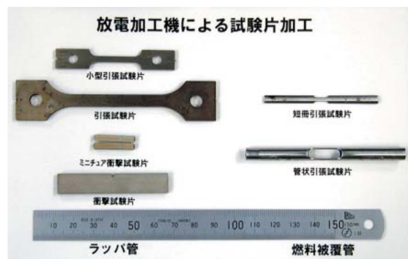
写真1 遠隔操作型精密試験片加工装置による試験片加工例
