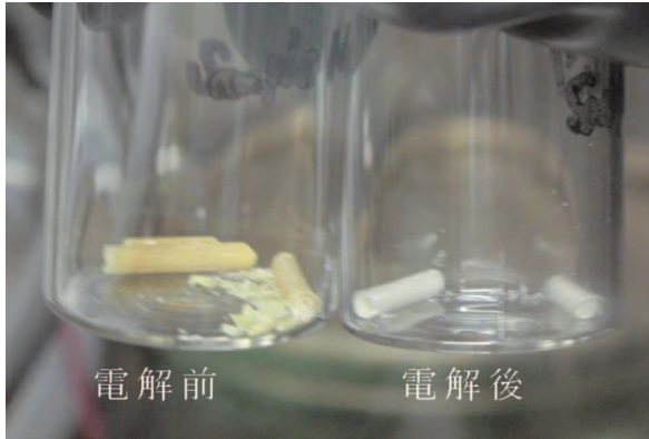
写真1 絞り電解前後の塩サンプル (ウラン塩化物は黄色を呈する)
