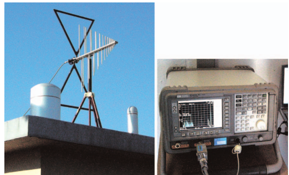
写真1 電波状況調査(左:受信アンテナの設置、右:周波数スペクトロメータ)
