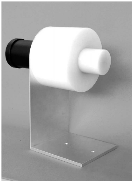
図1 軽量形中性子線量当量率サーベイメータ試作機の外観写真
