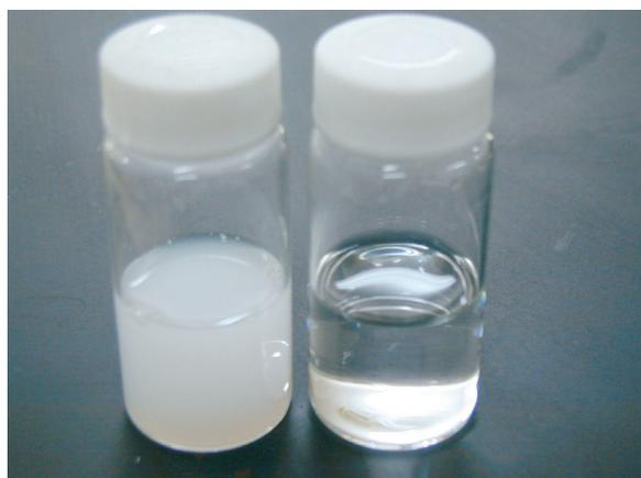
写真2 分解前の50%液体シンチレータ(左)と分解後の回収液(右)<sup>3)</sup>
