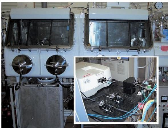
写真2 可視紫外吸光度測定試験装置
