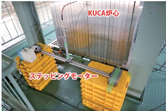
図1 KUCA炉心とステッピングモーター
