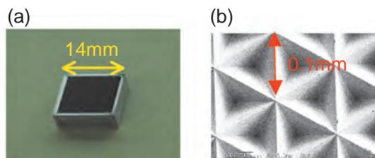
**Fig.3-17 Micro retro-reflector array**
