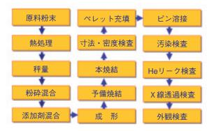
図 1-17 ホットセルにおける燃料製造プロセス 燃料ペレットから照射用燃料ピン製作までの流れを表 しています。
