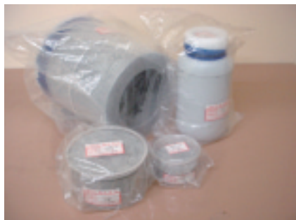
図12-1 様々な形状の標準体積線源 標準体積線源の作製は高い技術を要します。使用後の線源は放射性廃棄物として取り扱う必要があります。
