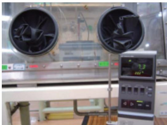
写真 8-1 導電率計の概要
