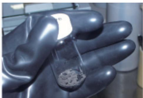
図7-11 蒸留窒化反応後に回収したプルトニウム窒化物粉末
