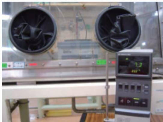
写真 8-1 導電率計の概要
