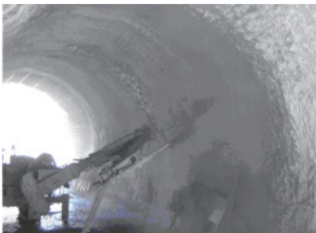
図 2-6 模擬トンネルを用いた吹付け試験の様子
