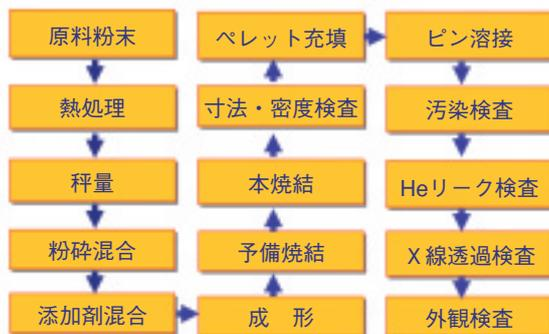
図1-17 ホットセルにおける燃料製造プロセス
