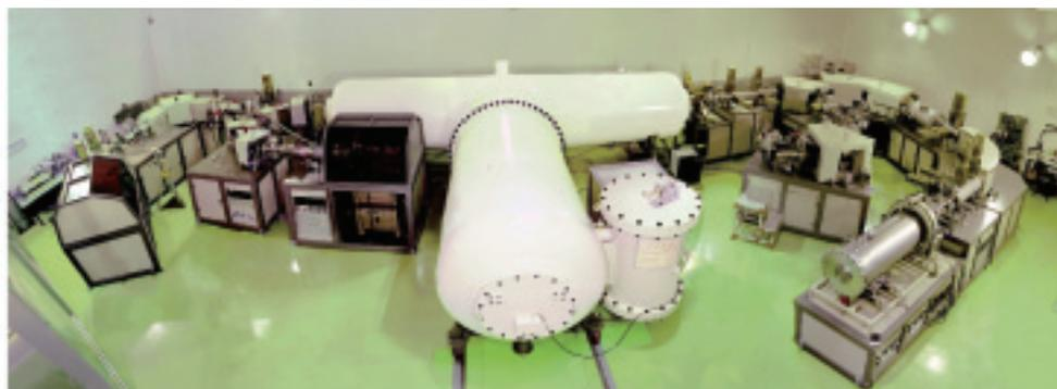
図12-19 むつ事業所に設置してある加速器質量分析装置(AMS)
