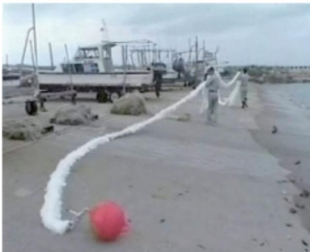
図 4-12 モール状のウラン捕集材を海域に係留する準備作業
