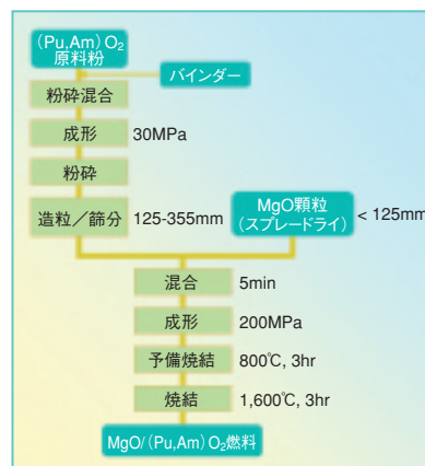
図1-8 MgOを母材とした高性能MA含有燃料作製フロー 既存MOX燃料作製技術への適合性を目的として、粉末冶金法を用いた工程により燃料を作製しています。
