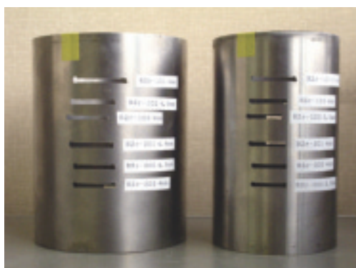
図9-3 切断状況(圧力管, カランドリア管の二重管構造同時切断)
