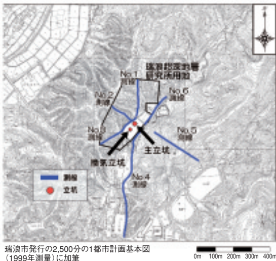
図 2-14 調査位置 掘削工場の振動を観測するために、地表に並べて設置している受振器の位置を示しています。受振器は、図中の青色実線部に10m間隔で設置しています。
