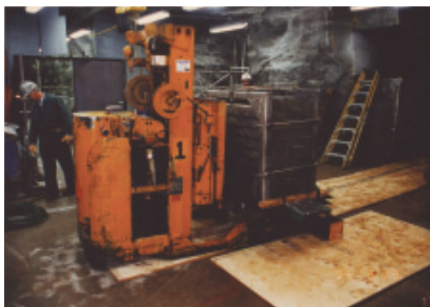
図 5-17 地下240mの坑道内で切り出した、き裂を含む約1 m 3 の花崗岩ブロック 切りくずが混入しないように、また、き裂（平均開口幅約0.3mm）が開いてしまわないように注意しながら、ダイヤモンドワイヤーソーで花崗岩ブロックを切り出しました。ブロックには放射性核種を注入したり、流出させたりするためのポートを取り付け、それ以外のブロック表面はシリコンコーティングして乾燥や酸化を防止しました。
