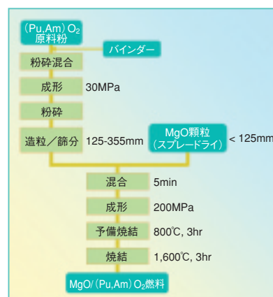
図1-8 MgOを母材とした高性能MA含有燃料作製フロー
