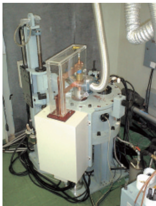
図 6-6 大容量型高温超重力場発生装置 雑誌Newton 2004年11月号にて紹介されました。
