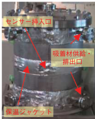
図 1-28 要素試験装置分離塔 内径48cmのステンレス鋼製の分離塔です。温度調整機能(保温ジャケット)や各種センサーの挿入口を有します。
