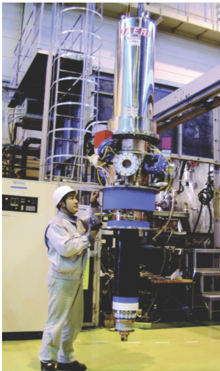
図 3-10 開発したITER用プラズマ加熱装置ジャイロトロン 高さ約3m、重さ約800kg。約7テスラを発生する超伝導コイルに挿入して使用します。出力窓には人工ダイヤモンドを使用しています。
