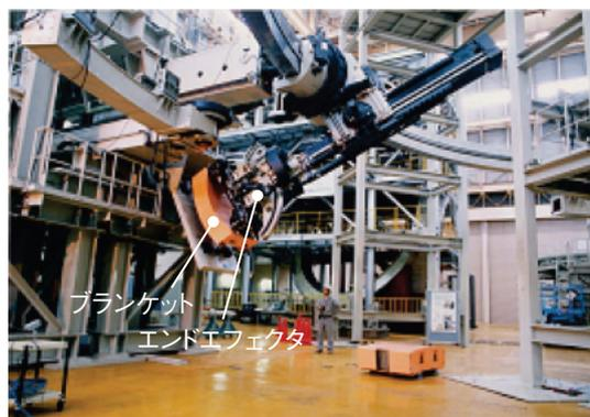
図3-16 ブランケットの高精度ハンドリング
