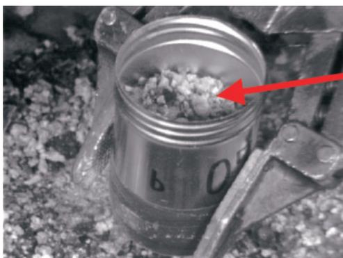
溶解工程から回収した不溶解残渣
