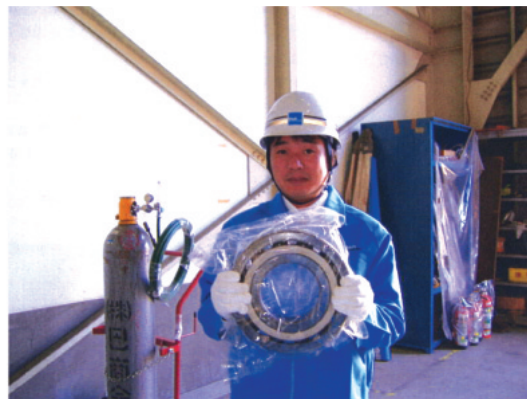
図 1-12 試験体 (実物大燃料交換機軸受)
