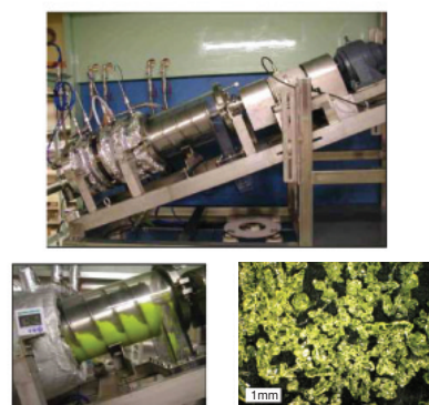
図1-25 晶析装置開発 晶析槽（約30cm径×90cm）中の溶解液5ℓを冷却し、生成した結晶（粒径：700～800μm）をスクリューにより上方へ移送する状況を示しています。装置の一部は観察のため透明樹脂製としています。
