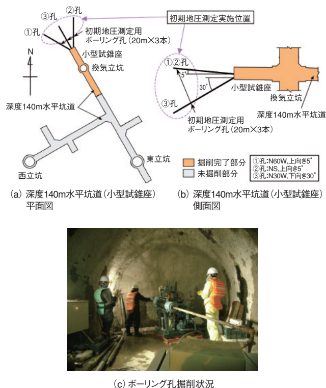
図 2-18 初期地圧測定位置とボーリング孔掘削状況
