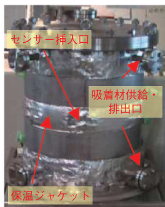
図1-28 要素試験装置分離塔 内径48cmのステンレス鋼製の分離塔です。温度調整機能(保温ジャケット)や各種センサーの挿入口を有します。
