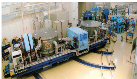
タンデム・ブースター加速器で加速した重イオンを、変形した原子核などに衝突させて、自然界には存在しない非常に重い元素を作る反応機構を調べるための反跳生成核分離装置
