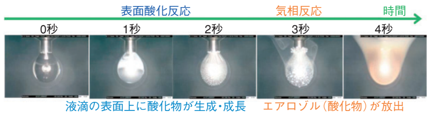
図 1-16 Na燃焼の事象推移 (酸素濃度20%の場合)
