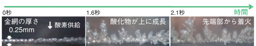
図 1-18 柱状酸化物の成長の様子
