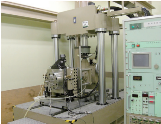
図 2-8 1/20縮尺規模の人工バリア模型を用いたせん断試験装置
