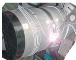
左図 配管突合せ溶接の様子 下図 溶接シミュレーション 時の温度分布 (赤色は溶融域)
