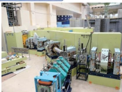
2008年度から稼働を開始したJ-PARC物質・生命科学実験施設(MLF)に建設中の $\mu$ SR分光器。超高感度で物質内部の磁場をとらえることで、物質中の電子や水素の状態を解明します。
