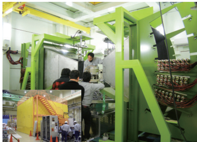
工学材料回折装置「匠」(MLF-BL19)の装置内部と装置全景(左下)パルス中性子を自動車エンジンや火力発電所ガスタービンなどの様々な工業製品に入射させ、製品内部のひずみを原子レベルで精密に評価し、実際の使用で問題となる製品の健全性評価や新製品の開発などに役立ちます。
