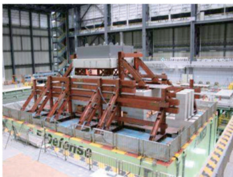
図 1-19 水平免震システムの試験状況
