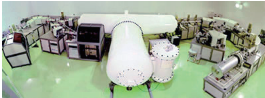
図14-29 青森研究開発センターに設置してある加速器質量分析装置 (AMS) この装置を用いることにより従来測定することのできなかった環境試料中の極微量の 129 Iを検出することができます。
