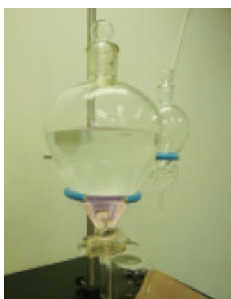
図14-33 海水試料からのヨウ素の抽出 上層の海水から下層の有機層に着色したことによりヨウ素が抽出されていることが分かります。
