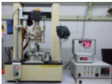
図3-30 開発した微小試験片用破壊靱性試験装置
