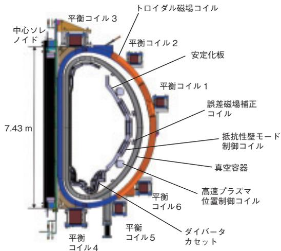
図 3-14 JT-60SAの断面図
