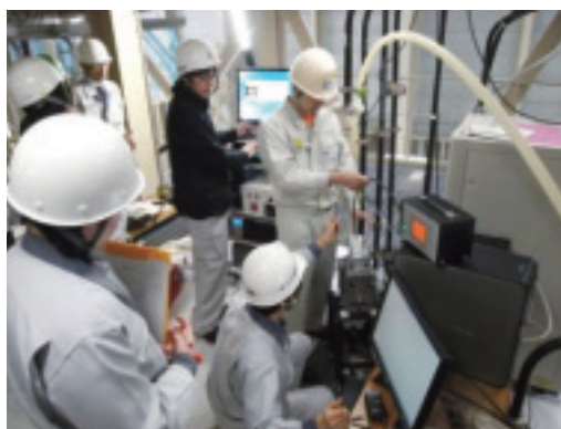
図 4-21 伝熱管内壁の検査補修の実演 敦賀市白木地区にある原子炉熱交換器の実物を模擬した試験装置を利用しました。実際の原子炉での検査補修を想定した訓練において、有効性を証明しました。
