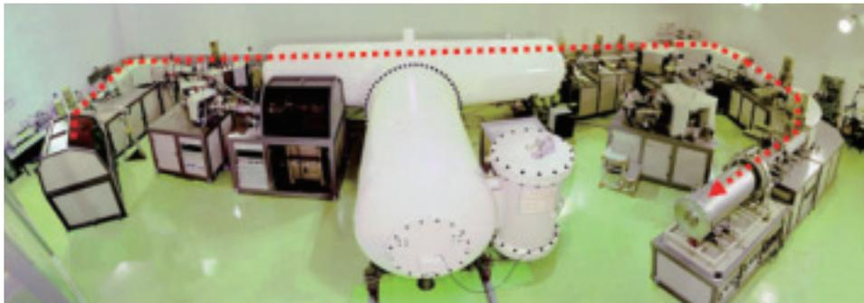
図14-32 国際相互比較測定に参加した青森研究開発センターむつ事務所に設置してあるAMS 中央に見える加速器に2本のビームラインが取り付けられており、<sup>129</sup>I測定には赤点線で示したビームラインを使用しました。
