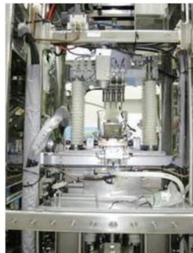
工学規模試験用ダイ潤滑成型機
