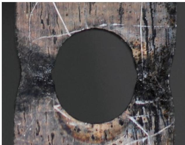
図 8-11 高照射を受けた構造不連続試験体の破壊直前の様子
