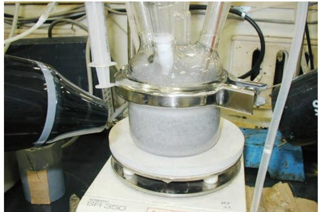
図10-1 硝酸塩分解試験状況
