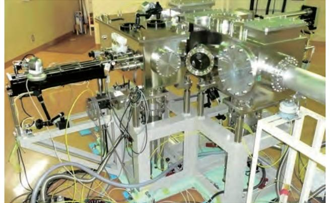
AVFサイクロトロンLBコースに整備した大面積均一イオンビーム形成・照射のためのチェンバー
