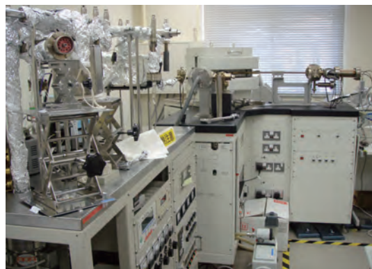
図 2-13 カリウム・アルゴン年代測定のための希ガス質量分析装置
