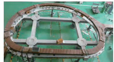
図3-3 1/3規模(5.1m×3.8m)のダブル・パンケーキの試作 絶縁含浸が終了し、完成した試作品です。
