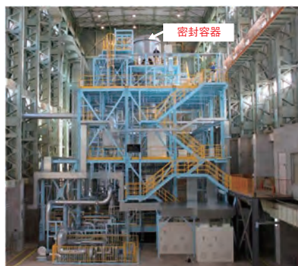
図 3-27 完成したIFMIF/EVEDA液体Li試験ループ Li保有量は2.5 t (5000 ㍓)、高さ20 m×幅15 m×奥行き15 mの 3フロア構造であり、最上部の密封容器内に試験部である ターゲットアセンブリがあります。
