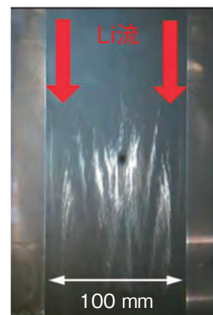
図 3-29 Liターゲットの様子 性能試験では、最終的にLiターゲットの流れを 生成することに成功し、安定に流れることを 確認しました(図 3-28中の観測窓を通して、 CCDカメラで撮影しました)。
