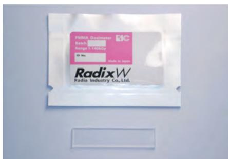
図12-23 透明PMMA線量計「Radix W」
