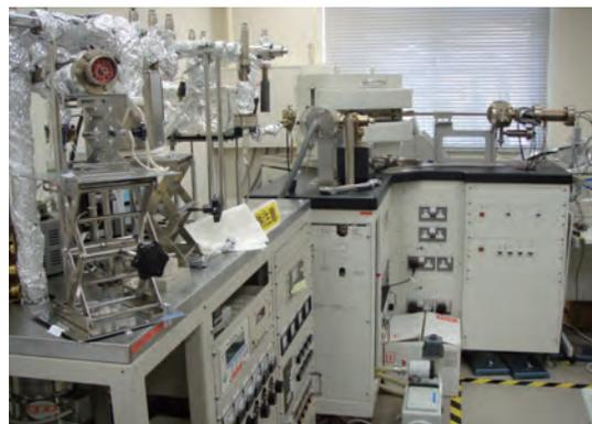
図 2-13 カリウム・アルゴン年代測定のための希ガス質量分析装置
