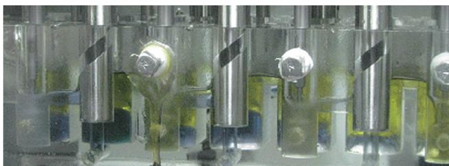
図 1-35 分配部におけるPu逆抽出試験の様子(供給液 Pu/U: 3%)
