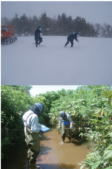
図 2-24 表層水理調査の様子 (上)積雪期における積雪水量調査の様子です。積雪期の調査時には雪上車を活用します。 (下)非積雪期における河川流量観測の様子です。非積雪期には長袖上着2枚、防護網、皮手袋を着用し、虫除け剤を使用します。
