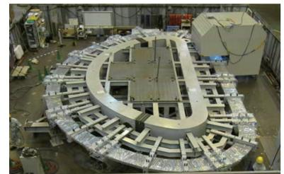
図3-4 実規模(13 m×8 m)ラジアルプレートの試作
