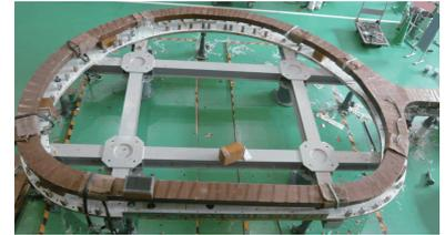
図3-3 1/3規模(5.1 m×3.8 m)のダブルパンケーキの試作
