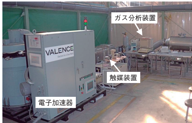
図 4-19 電子加速器と二酸化マンガン触媒層等から成る実規模有害有機物分解試験装置
