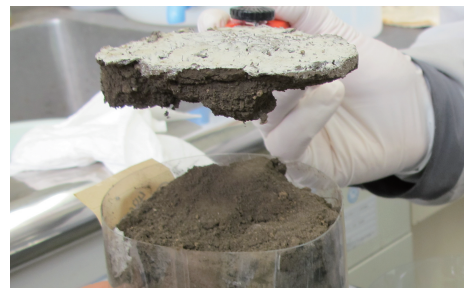
図7-3 ポリイオンを用いた土壌表面固化技術の開発
